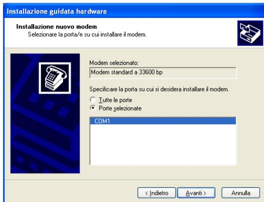
NOTA: La porta su cui installare il nuovo Modem dipende dalle impostazioni del proprio PC e il valore corrisponde alla porta fisicamente utilizzata per la connessione Seriale tra il PC e l'interfaccia CL111, qui configurata come "modem").
