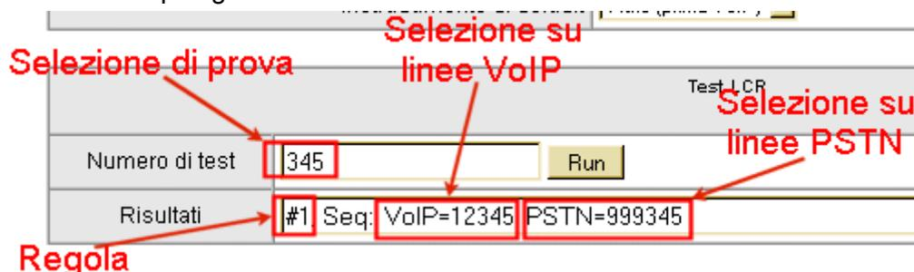
Nell'esempio in figura, la selezione di prova "345" è prevista dalla regola "1" e verrà sostituita su linee VoIP dalla selezione "12345", sulle linee PSTN dalla selezione "999345".
