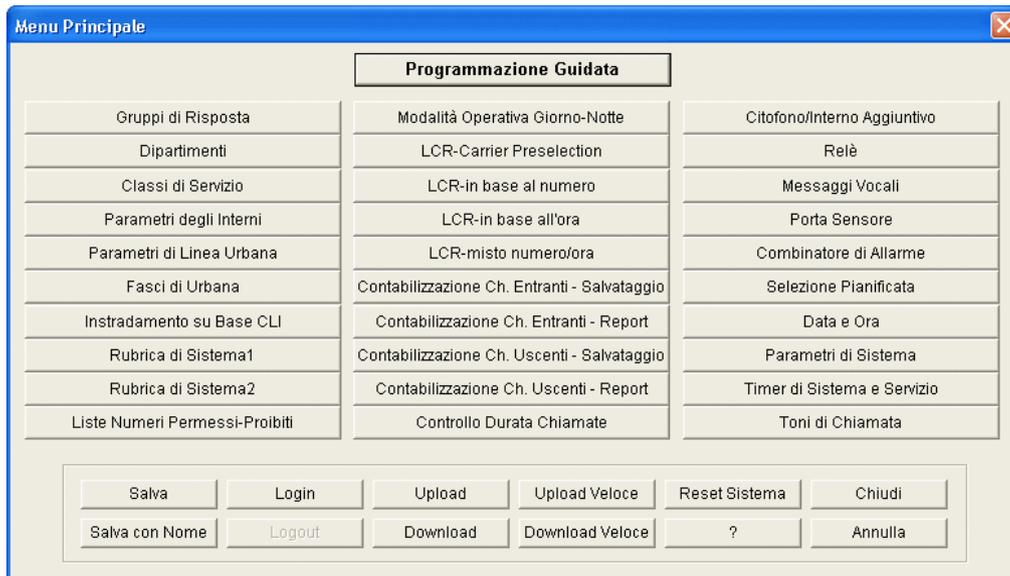
La finestra 'Menu Principale' del software SL-set mostra nella parte superiore tutte le funzioni a disposizione, disposte in ordine logico di programmazione. E' sufficiente fare click sul titolo di una funzione per accedere ad essa.
