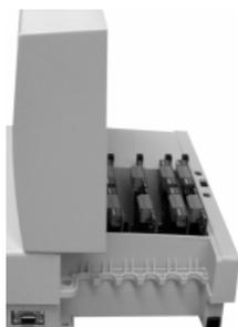
3) Completare la rotazione del coperchio fino a porlo in posizione perpendicolare all'armadio
