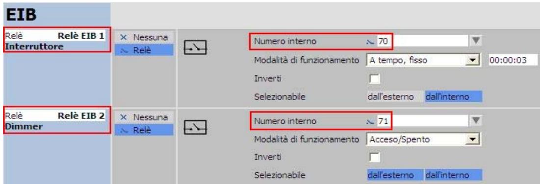
I relè così configurati potranno essere gestiti manualmente con i tasti funzione "Relè" programmabili sui telefoni XF-phone oppure in modo automatico per mezzo della funzione "Timer".
