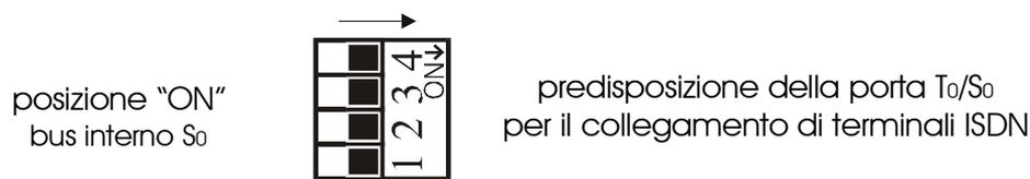
Gli apparati utilizzabili possono essere indifferentemente telefoni di sistema **XF-phone TI50/TI100** (max 2 per ogni bus S<sub>0</sub> interno predisposto), telefoni ISDN, fax di gruppo 4, modem ISDN, dispositivi di videoconferenza o di trasmissione dati, router, ecc.
