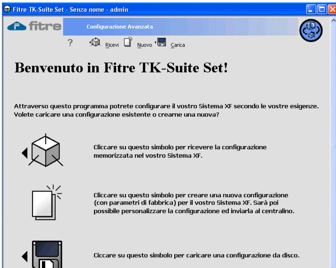
Per caricare la configurazione correntemente presente nel centralino, cliccare sull'icona "Ricevi". Il programma leggerà le impostazioni del vostro Sistema XF; al termine del caricamento, apparirà la schermata principale del programma.
