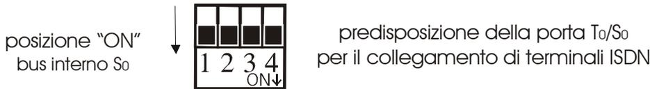
Gli apparati utilizzabili possono essere indifferentemente telefoni di sistema **XF-phone TI50/TI100** (max 2 per ogni bus S<sub>0</sub> interno predisposto), telefoni ISDN, fax di gruppo 4, modem ISDN, dispositivi di videoconferenza o di trasmissione dati, router, ecc.
