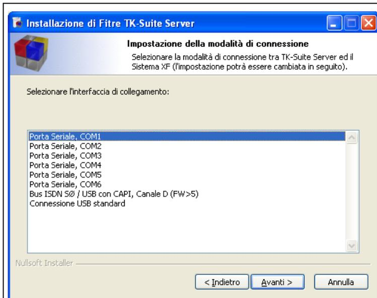
Selezionare l'interfaccia di collegamento tra TK-Server ed il Sistema XF.
