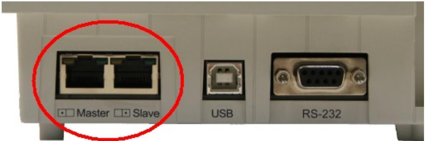
Per creare un sistema Combo, collegare un'estremità del cavo di rete CAT 5 alla porta "MASTER" di un XF550 e l'altra estremità alla porta "SLAVE" del secondo XF550; il centralino con il collegamento sulla porta MASTER sarà il "Master" del sistema XF500Combo, mentre l'altro sarà lo "Slave"
