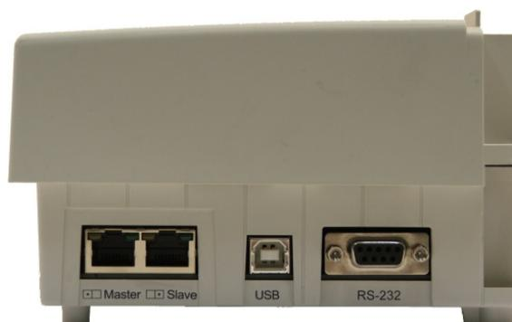
All'esterno dell'armadio, ubicate sul lato inferiore sinistro, si trovano la porta seriale RS-232C e la porta USB, per la connessione di un PC per la configurazione dell'impianto e le funzionalità CTI; alla porta seriale è anche possibile collegare una stampante per la documentazione degli addebiti. Il modello XF550 è inoltre equipaggiato con le porte Master/Slave per l'interconnessione ad un altro Sistema XF550.
